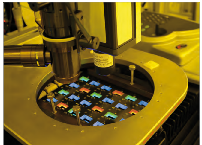
Prober mit mikrostrukturierten OLEDs im Reinraum des Fraunhofer FEP
