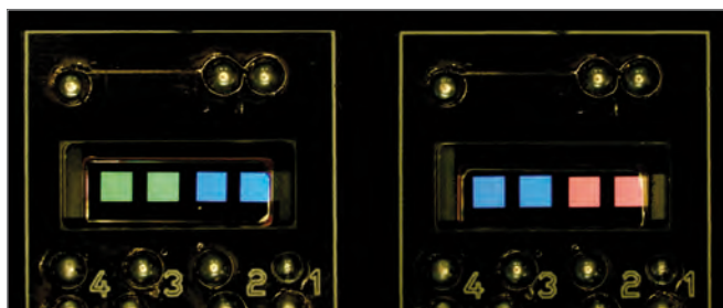
Mit Elektronenstrahl mikrostrukturierte Test-OLEDs auf Siliziumsubstrat
