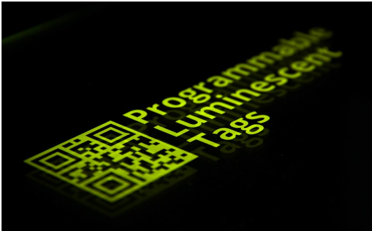
Bild1: Ein leuchtendes Etikett, kontaktlos aufgedruckt auf eine Plastikfolie. Die leuchtende Schicht ist dünner als ein menschliches Haar. Der Aufdruck lässt sich berührungslos wieder löschen und durch ein anderes Muster ersetzen. Bildrechte: M. Gmelch und H. Thomas, TU Dresden
