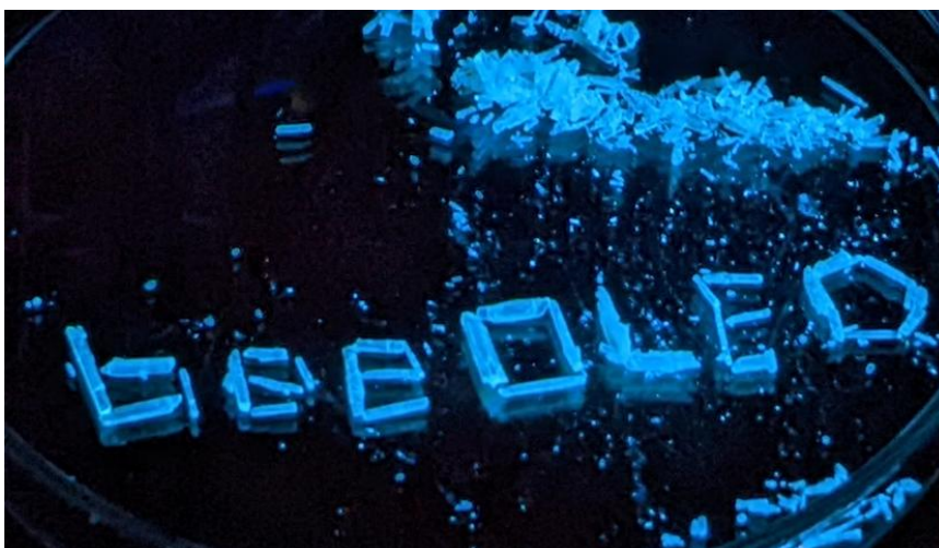
Perfekte Kristalle gezüchtet für XRD (Röntgenstrukturanalyse). Unter UV-Licht-Bestrahlung wird tiefblaues Licht emittiert.
