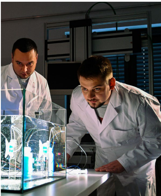
Biomimetische Fischflosse mit dielektrischen Elastomeraktoren und Faserverstärkung; © ITM/TUD
