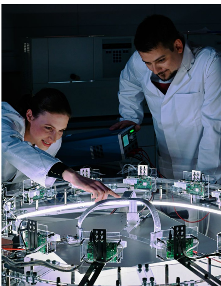
Doktorand:innen arbeiten gemeinsam an einem Multi-Kamerasystem zur Verformungsmessung von interaktiven Faser-Elastomer-Verbunden; © ITM/TUD
